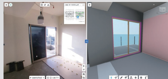
BIM 模型能與現場施作過程及結果進行比較，確認現場是否依照檢討規劃結論施作。
