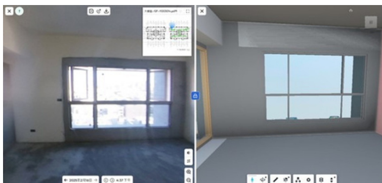
將Google街景模式導入工地現場記錄及保存。
